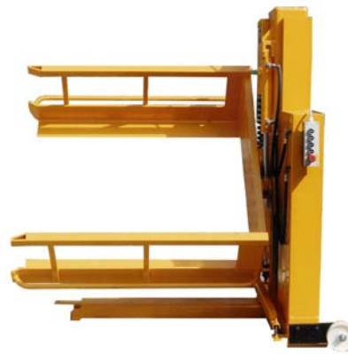
NIVOMAT EHP- elektrohydr. 30°- 45° (rechts und links) schwenkbar
